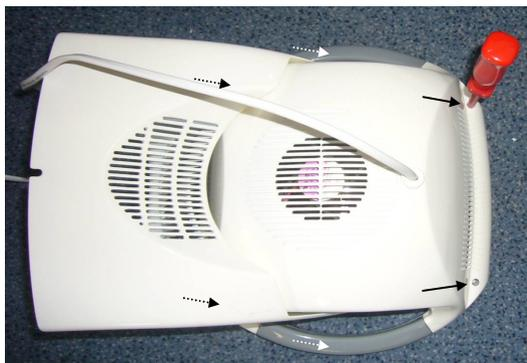
3. Поднимите корпус, при этом оставьте лежать переднюю часть со стеклокерамической панелью на подложке.
