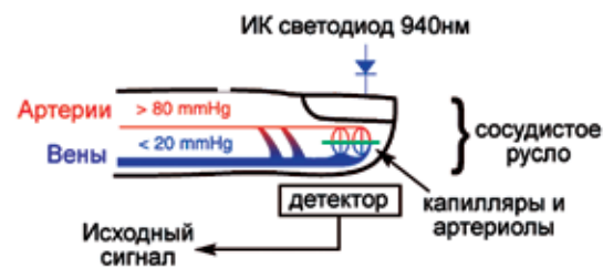
Рис. 2. Схема работы оптического датчика
