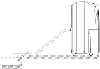
Для непрерывного отвода конденсата используйте шланг внутренним диаметром 16 мм.
