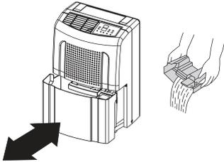
1. При заполнении бака загорается индикатор "FULL WATER". Прибор отключается.
